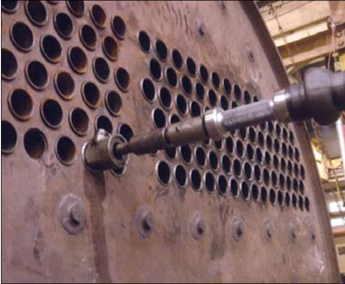
组合式卷边扩张器和 90° 直角 气动管式滚筒配合使用
