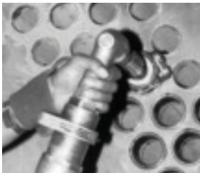
Expansor Rebordeador en uso con Motor de Rolado Neumático 909
